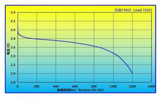
电阻容量曲线 Load-capacity
