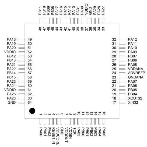
Figure 3-9. ATSAM4LS TQFP64/QFN64 Pinout
