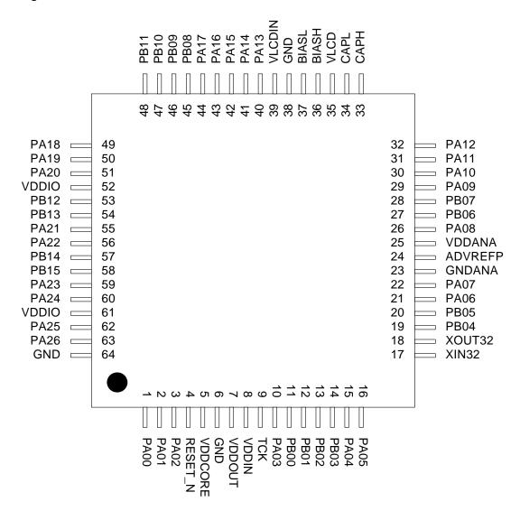
Figure 3-4. ATSAM4LC TQFP64/QFN64 Pinout
