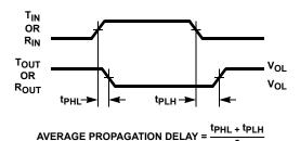
FIGURE 6. PROPAGATION DELAY DEFINITION
