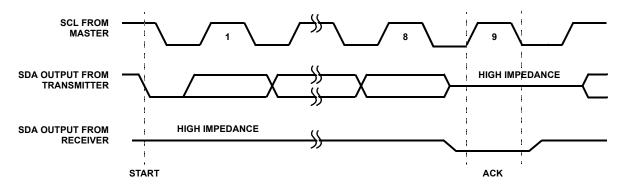
FIGURE 13. ACKNOWLEDGE RESPONSE FROM RECEIVER
