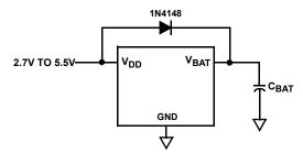
FIGURE 21. SUPERCAPACITOR CHARGING CIRCUIT
