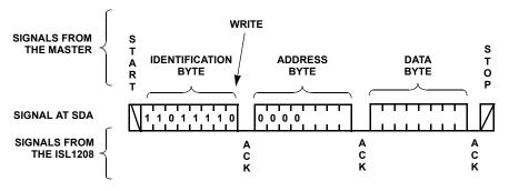
FIGURE 14. BYTE WRITE SEQUENCE
