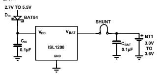
FIGURE 20. POWER GLITCH PROTECTION CIRCUIT
