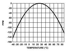
FIGURE 17. RTC CRYSTAL TEMPERATURE DRIFT
