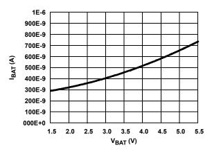
FIGURE 1.  $I_{BAT}$  vs  $V_{BAT}$
