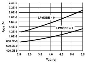
FIGURE 4.  $\rm I_{DD1}$  vs  $\rm V_{CC}$  WITH LPMODE ON AND OFF
