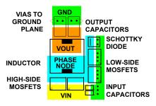
FIGURE 14. TYPICAL POWER COMPONENT PLACEMENT
