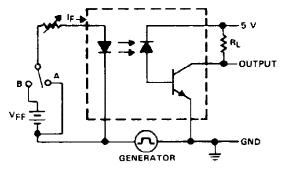
TEST CIRCUIT (EACH CHANNEL)
